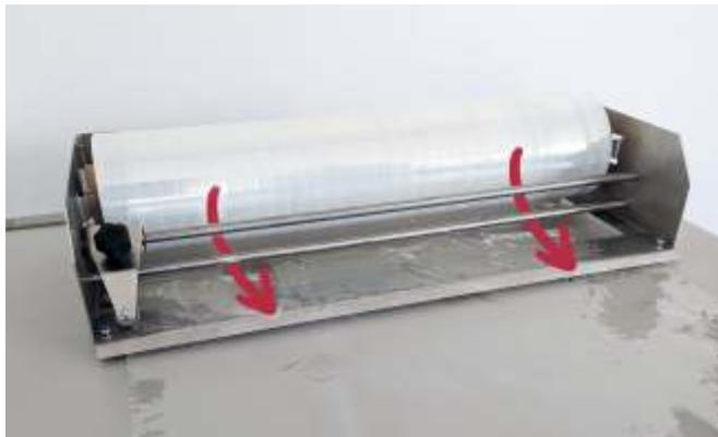
Damit das Abrollen bzw. Abschneiden der Folie funktioniert, muss die Folie unterhalb der beiden Metallstäbe (s. Fotos) eingelegt werden.
