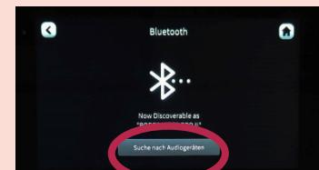
Um ein Audiogerät (z. B. ein Mikrofon) per Bluetooth zu verbinden, öffnet man zunächst die **Einstellungen** am Touchscreen des Mischpults, navigiert dann zu „**System**“ und „**Bluetooth**“ und tippt zuletzt auf „**Suche nach Audiogeräten**“. Hier werden dann verfügbare Geräte in der Nähe zum Auswählen angezeigt.
