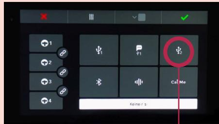
Dann wählt man den Kanal aus, an dem man das Gerät angeschlossen hat. In diesem Fall also das USB-Symbol mit der Zahl 2.
