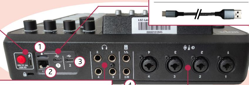
Am USB-Anschluss 1 wird das Mischpult via USB-Kabel mit dem Computer verbunden.
