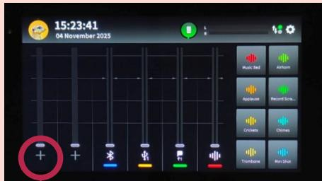
Zuerst tippt man am Touchscreen auf das Symbol unterhalb des gewünschten Reglers. Wenn kein Gerät zugeordnet ist, wird hier ein Plus-Symbol angezeigt.
