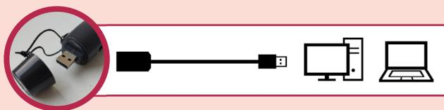
Um eine Verbindung via USB herzustellen, nimmt man die Schutzhülle am Fuß des Geräts ab und verbindet es im ausgeschalteten Zustand mit dem gewünschten USB-Eingang. Dafür kann auch das beiliegende Verlängerungskabel verwendet werden. Die Aufnahmen können nun im Ordner „MIC\_REC“ gefunden werden.
