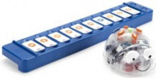
Der Blue Bot kann im Gegensatz zum Bee Bot zusätzlich mit einer Programmierleiste gesteuert werden. Dadurch bieten sich viele weitere Möglichkeiten und Erweiterungen in den Programmierungen.
